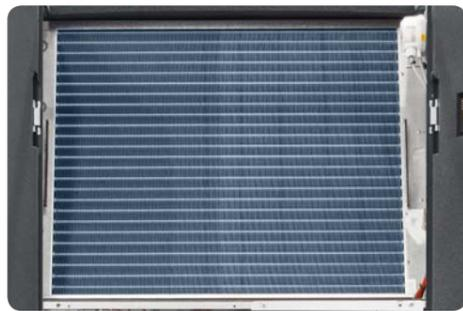
Alle Modelle der Baureihe **JREF DX** sind serienmäßig mit Wärmetauscherregistern mit **hydrophiler Behandlung** ausgestattet. Die spezielle Verkleidung und eine angemessene Wahl der Durchquerungsgeschwindigkeit des Luftstromes begünstigen das Aufnehmen des Kondenswassers im Entfeuchtungsprozess, wodurch das Nachziehen von Tropfen inner- und außerhalb des Geräts vermieden wird.
